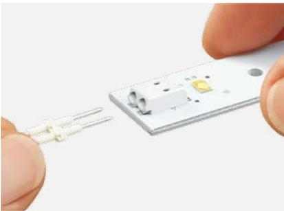
步骤1：将跨接器插入PCB板上接线端子的进线孔中。
