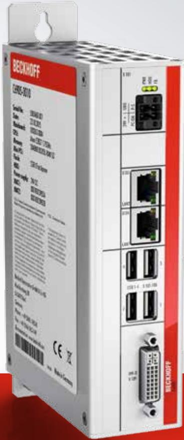
“经济型”控制柜式 PC C6905 进一步完善了 C69xx 系列紧凑型 and 中等性能等级的型号。C6905 无风扇型工业 PC 是为控制柜安装而设计的。紧凑型铝质机箱，配备 3.5 英寸主板，采用 Intel® Atom™ 处理器，最高四核，所有 PC 接口均置于机箱前部。
